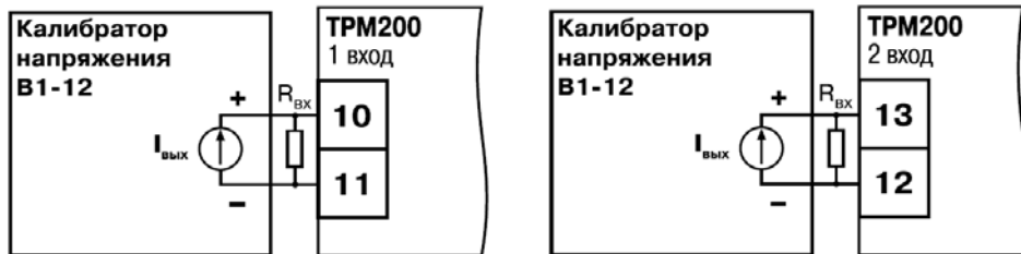
Рисунок Ж.3 ( R_{\text{вх}} = 100 \text{ Ом} \pm 0,1\% )
